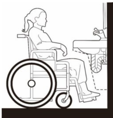
perletakan bak cuci tangan harus mudah diakses oleh pengguna kursi roda
